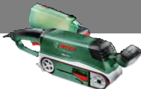
LIJADORA DE BANDA PBS 75 A BOSCH 710 W. Sistema Microfiltro. Sistema de sujeción de la banda automático. Empuñadura adicional. Velocidad de banda de 350 m/min. Dimensiones de la banda 76 x 165 mm. Banda de lija P80. Caja.
